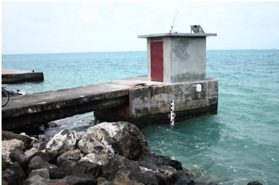
*Figure 17 : Le marégraphe de l'île de Tubuai (Australes), installé par l'OGT en 2008 (radar et GPS) avec l'aide du SHOM. Le radar altimétrique est sur le flanc du duc d'Albe, à côté de l'échelle de marées. L'antenne GPS (radôme) est visible sur l'arrière-plan, avec l'antenne de communication Yagi (râteau) visant le satellite GOES-West de la NOAA. La station a résisté en 2010 au cyclone Oli, qui a frappé directement l'île.*
